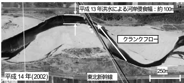
写真-1 鬼怒川のクランクフロー [東北新幹線地区, 94k]
